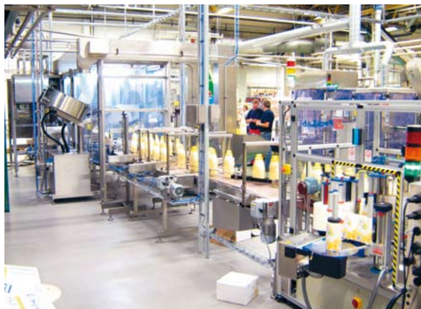
Leveransen av en komplett fyllningslinje till norska Lilleborg i höst är en av Trepaks större på senare år.
