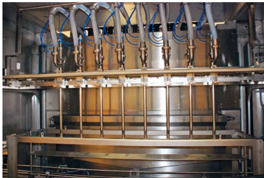
Den sidoflyttande fyllbryggan med fyllrören står i viloläge emellan de båda flaskbanorna. Längst in sitter disklådan som fyllrören sänks ner i vid rengöring.
