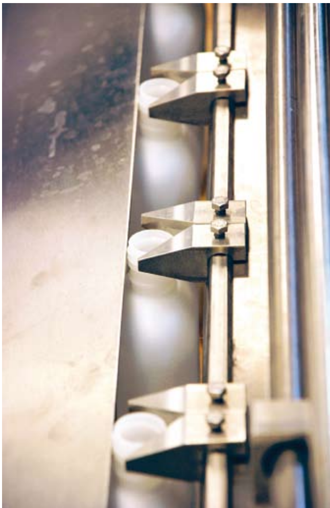
Flex Format Unit fixerar flaskhalsen i fyllningsläge på den minsta flaskan – 200 ml.
